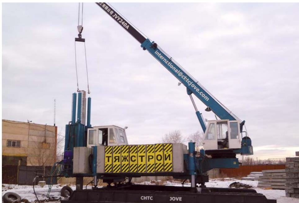
личной скоростью и усилием, высокой точностью погружения. Непрерывный контроль усилия вдавливания позволяет оценить несущую способность сваи в процессе погружения, оптимизировать расчетную нагрузку и количество свай в проекте и, обеспечивая заданную несущую способность, свести к минимуму затраты на возведение фундамента.
